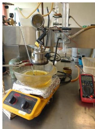
Figura 26. Sistema de calentamiento y calibración del Termopar
