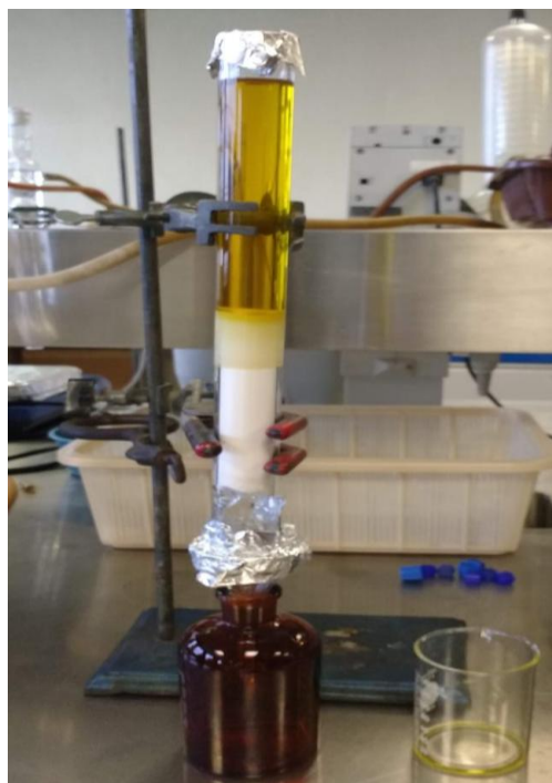
Figura 29. Purificación del ALV con una columna empacada con \alpha -alúmina
