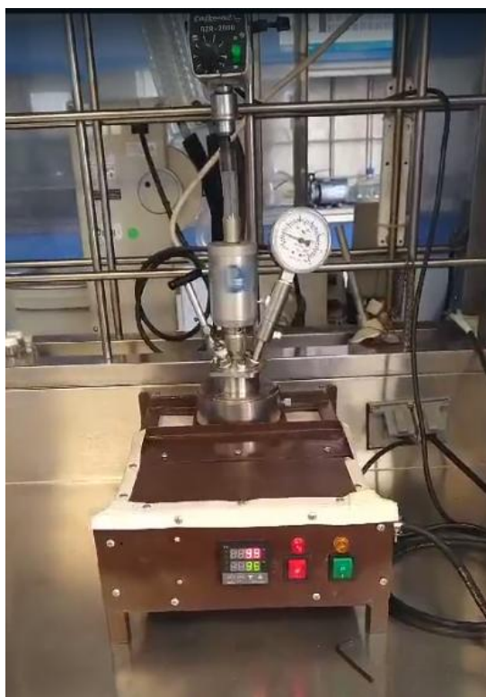
Figura 32. Equipo de laboratorio para la reacción de carbonatación de ALE.
