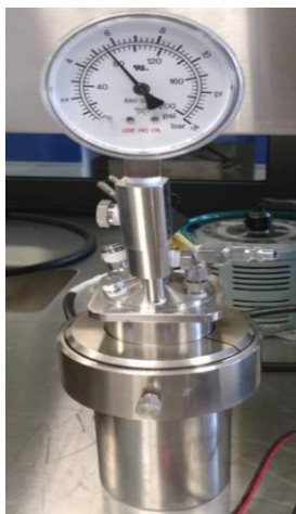
Figura 25. Reactor de alta presión para la reacción de carbonatación
